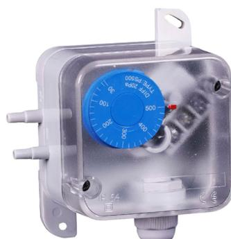
PS500 Реле давления дифференциальное для воздуха с комплектом соединительных деталей, 30...500Па, IP54
