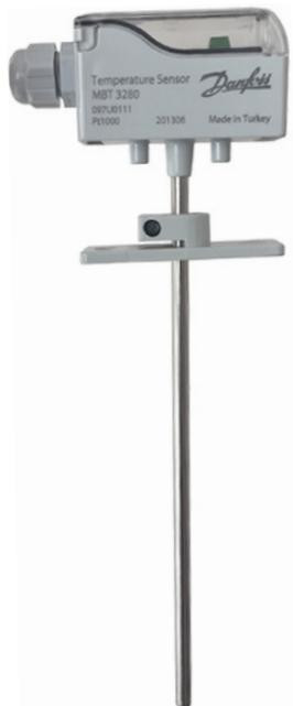
097U0112 Датчик температуры каналный MBT3280, длина погружной части 200 мм, с эл.разъемом, класс защиты IP65 в комплекте с фланцем, NTC10K
